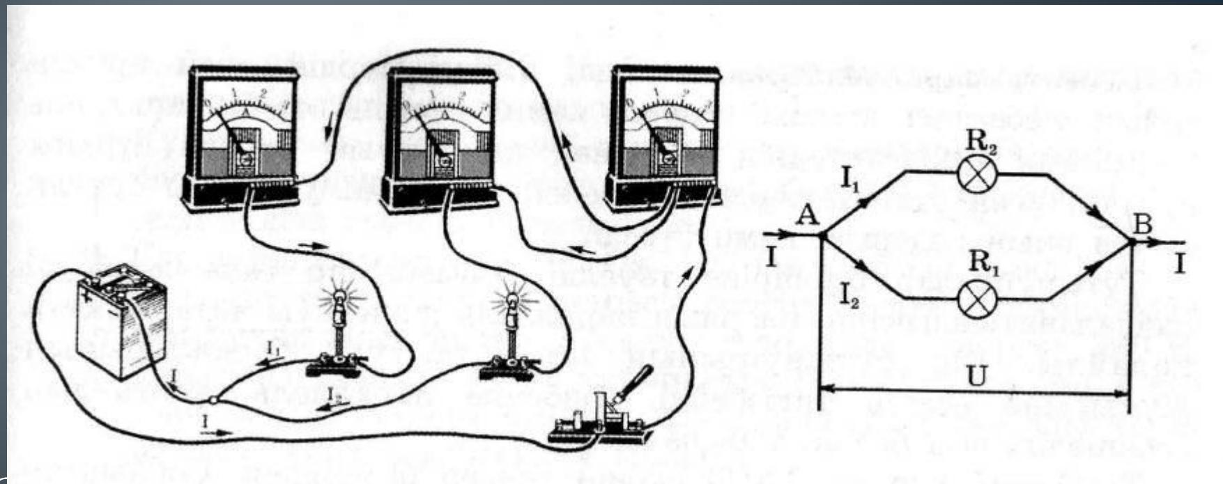
Электртвоегинің екі өткізгіштен артық өткізгіштер түйісетін нүктесін түйін (суретте А және В нүктелері) деп атайды.
