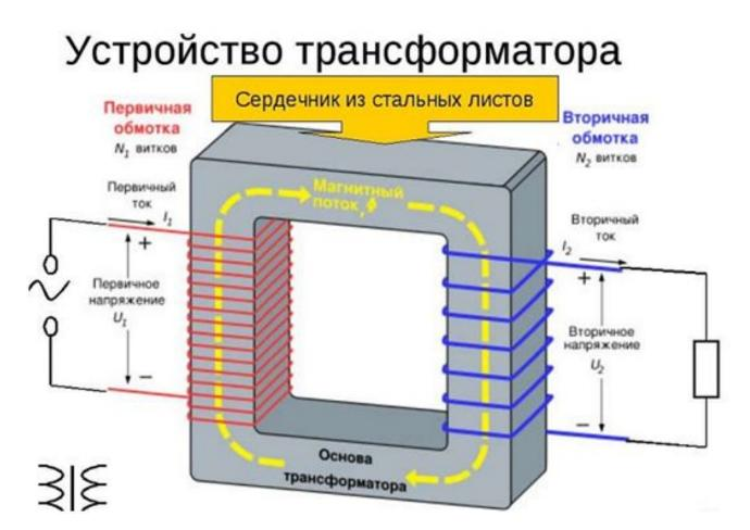
•Передача переменного тока от электростанции до дома происходит по следующей схеме: вначале генератор производит напряжение порядка 25 кВ, затем это напряжение повышается трансформатором до примерно 750 кВ, передаётся на ЛЭП, а затем на подстанции оно понижается до 220 В (ну, амплитуда 311 В, но среднее значение всё же 220 В, а лампочка светится пропорционально среднему значению, а не максимальному), и дальше мы им пользуемся.
