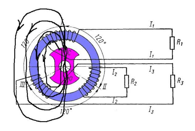
Когда полюс направлен на обмотку, в ней поток околонулевой, когда обмотка сбоку от полюса, в ней поток максимальный. Обычно на электростанциях генератор вращает турбина – паровая или водяная. В автомобиле генератор вращает поршневой двигатель.
