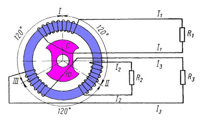
Когда ротор вращается, магнитный поток в катушках меняется – чтобы это увидеть, достаточно взглянуть на линии магнитного поля.
