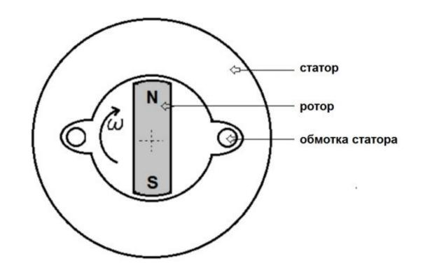
• Ниже показана схема реального электрогенератора – на неё видны магнит (ротор), общий сердечник катушек, сами катушки (статор). Такой генератор называется трёхфазным и он представляет из себя сразу три источника напряжения – так уж вышло, что на практике проще сделать генератор, являющийся сразу тремя источниками, чем генератор, который был бы одним источником аналогичной мощности.
