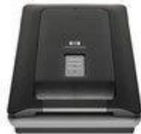
**Сканер** – устройство, которое, анализируя какой-либо объект (обычно изображение, текст), создаёт цифровую копию изображения объекта. Процесс получения этой копии называется *сканированием*. В большинстве сканеров для преобразования изображения в цифровую форму применяются светочувствительные элементы на основе приборов с зарядовой связью. По способу перемещения считывающей головки и изображения относительно друг друга сканеры подразделяются на *ручные, рулонные, планшетные* и *проекционные*.
