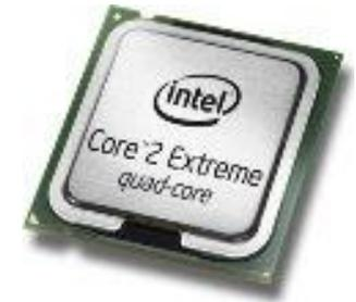
**Центральный процессор** (ЦПУ, CPU, от англ. Central Processing Unit) — это основной рабочий компонент компьютера, который выполняет арифметические и логические операции, заданные программой, управляет вычислительным процессом и координирует работу всех устройств компьютера. Современные процессоры выполняются в виде микропроцессоров (МП)
