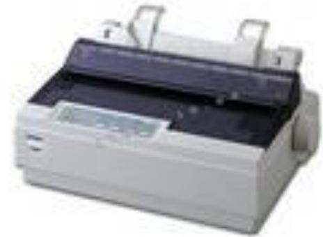
**Принтеры** предназначены для вывода на бумагу числовой, текстовой и графической информации. По своему принципу действия принтеры делятся на *матричные, струйные и лазерные*.
