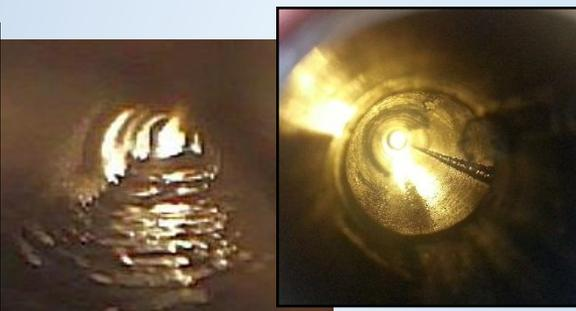
Трубопровод Ду=68 мм, заполненный битумом
