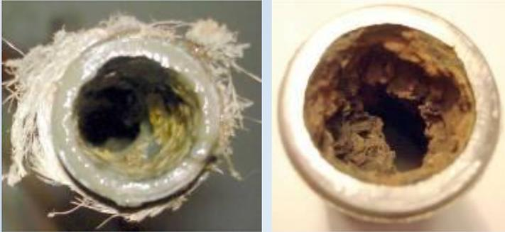
Из кожухотрубных теплообменных аппаратов
