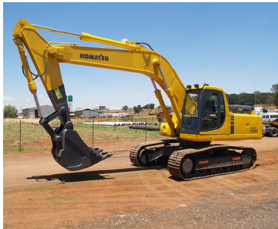
Рис. 4. Экскаватор гидравлический с обратной лопатой на гусеничном ходу
