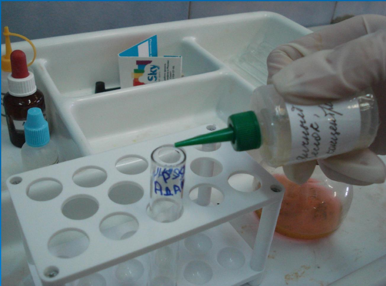
Добавляют 10 капель уксусной кислоты ( $\text{CH}_3\text{COOH}$ )
