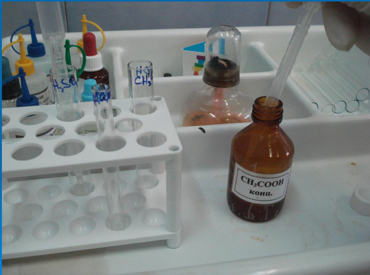
Наклонив пробирку, осторожно по стенке добавляют каплями около 0, 5мл серной кислоты ( $H_2SO_4$ ) так, чтобы жидкости не смешивались.
