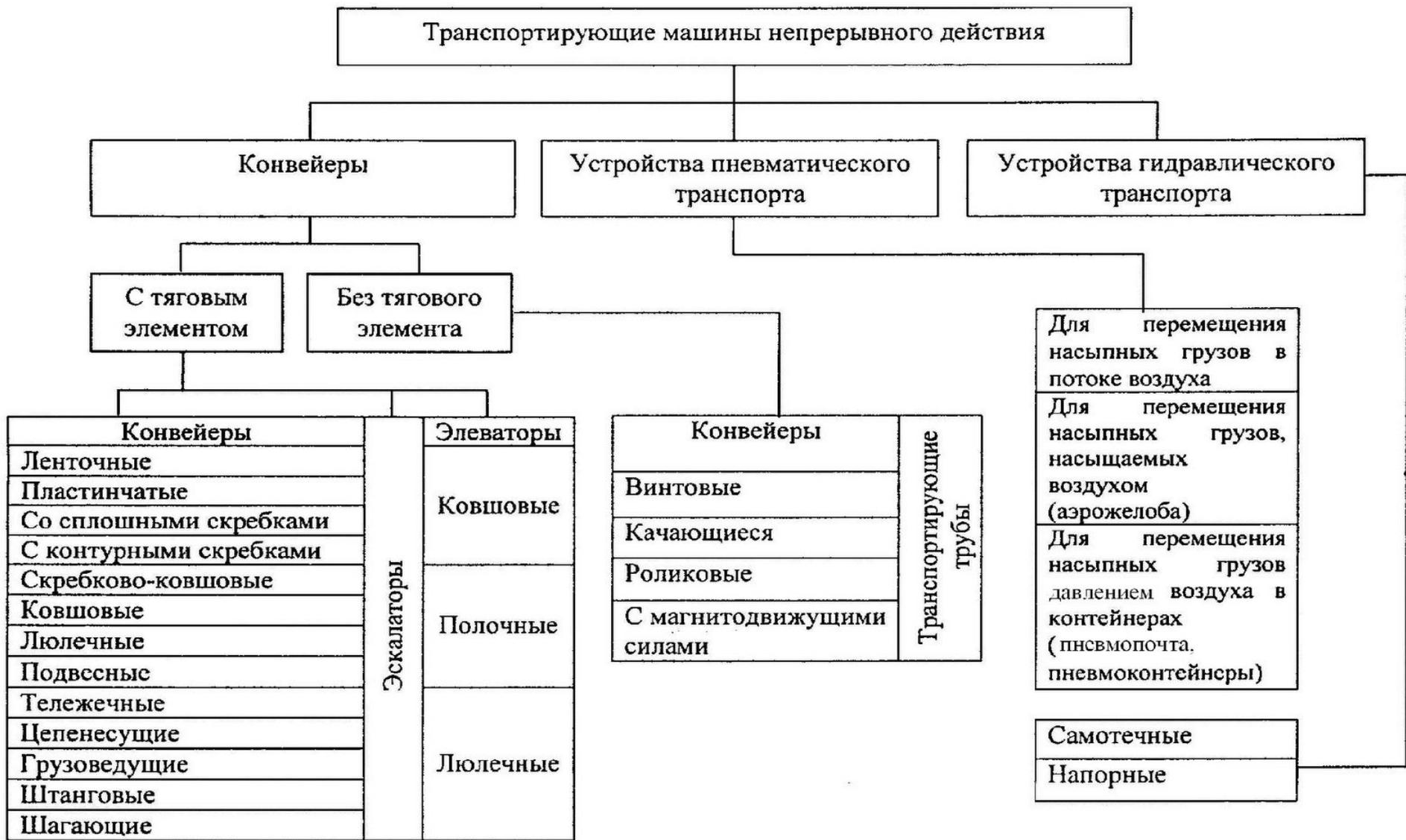
Рис. 1.1. Классификация транспортирующих машин непрерывного действия
