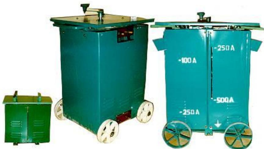
Однофазные, однопостовые сварочные трансформаторы предназначены для ручной дуговой сварки покрытыми металлическими электродами. Имеют падающие внешние характеристики.
