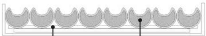
Основной удлиненный заряд Дополнительные удлиненные заряды
