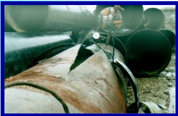
Положение муфты КСЛ после разрыва
