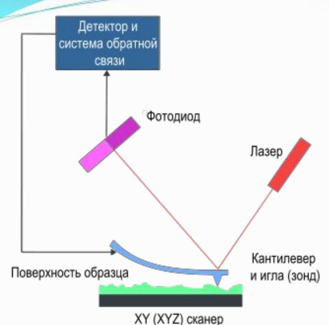
На расстоянии около одного ангстрема между атомами образца и атомом зонда (кантилевера) возникают силы отталкивания, а на больших расстояниях - силы притяжения.
