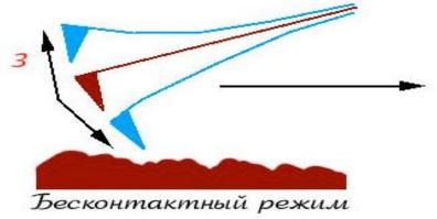
Кантилевер жестко связывается с пъезоэлементом и колеблется со своей резонансной частотой. Детектируется не только амплитудное отклонение, но и фазовое.
