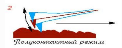
Бесконтактный и полуконтактный режим характеризуются дополнительным условием сканирования, которое позволяет осуществить более щадящее и тонкое сканирование.
