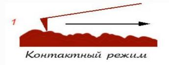
Кантилевер непосредственно касается поверхности и повторяет её форму по мере прохождения поверхности
