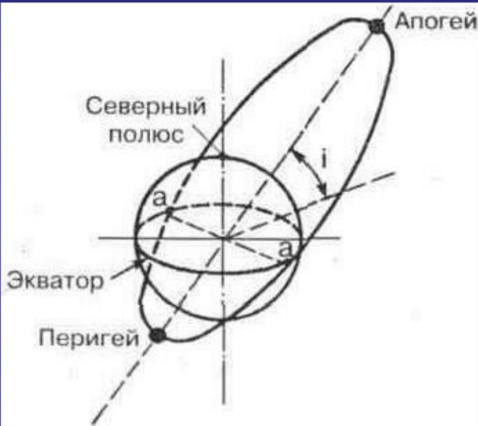
Рис. 3.1. Наклонная эллиптическая орбита ИСЗ
