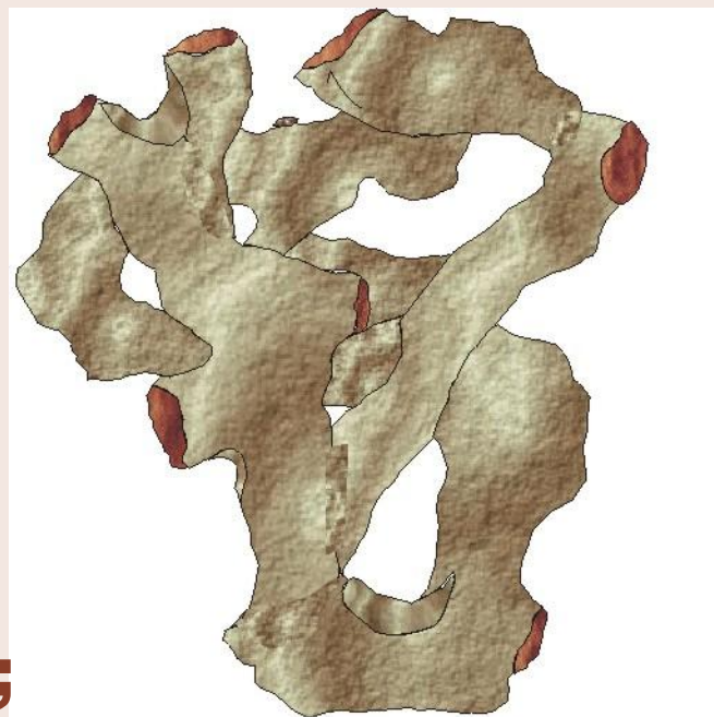
Рис.5. Слепок поровых каналов сцементированного песчаника
