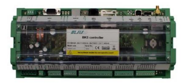
В качестве управляющего контроллера системы «умный дом» наиболее оправдано применение одноплатного компьютера промышленного исполнения. Подобные компьютеры отличаются небольшим размером, малой потребляемой мощностью, отсутствием механических частей (вентиляторы, жесткие диски) и работают на программном обеспечении с открытым исходным кодом. Количество и тип имеющихся интерфейсов в большинстве случаев можно изменять и дополнять.
