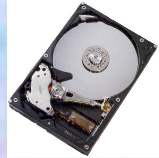
**Ёмкость винчестера** определяется максимальным объемом данных, которые можно записать на носитель. Реальная величина ёмкости винчестера в настоящее время варьируется от 80 Гб до 500 Гб (реже до 1 Тб).
