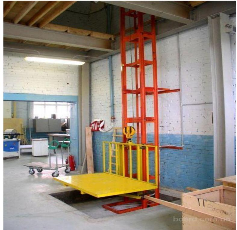
Это оборудование используют на предприятиях для межэтажного перемещения грузов, а также при ремонте и монтаже оборудования. К грузоподъёмному оборудованию относят: лебёдки с ручным электрическим приводом; тали и тельферы, применяемые для вертикального и горизонтального перемещения грузов.
