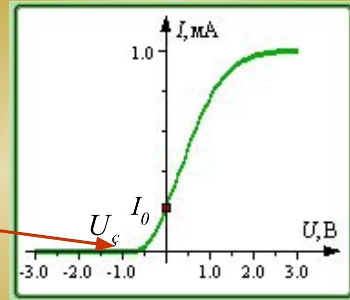
При  $U > U_c$  в результате облучения электроны, выбитые из электрода, могут достигнуть противоположного электрода и создать некоторый начальный ток.
