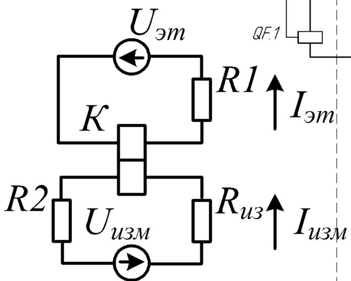
*Дифференциальная схема контроля сопротивления изоляции сети*
