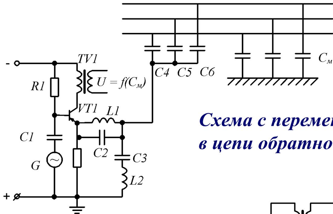
*Схема с переменным сопротивлением в цепи обратной связи усилителя*
