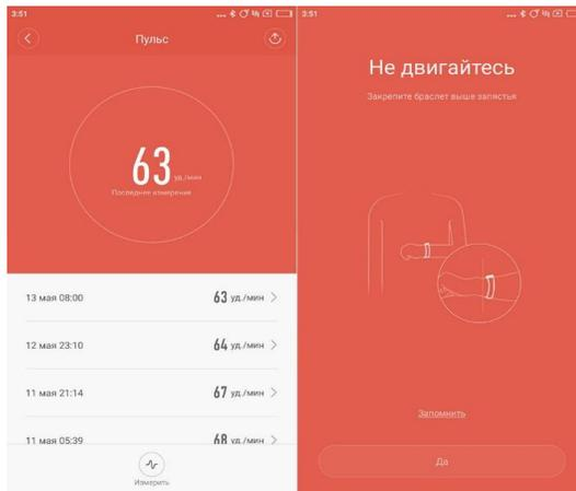
Что же касается измерения пульса, то пульсометр Mi Band 2 способен работать как в автоматическом режиме (нажатием на сенсорную кнопку, вызвав соответствующий пункт меню), так и через приложение Mi Fit. Отличие в том, что при вызове через приложение измерение попадут в базу, а по нажатию на кнопку трекера они просто отобразятся на дисплее браслета.
