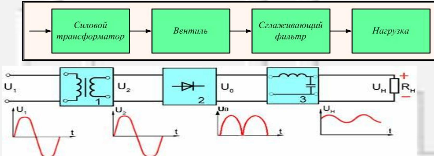
**Силовой трансформатор** – преобразует переменное питающее напряжение (необходимое напряжение, гальваническая развязка).
