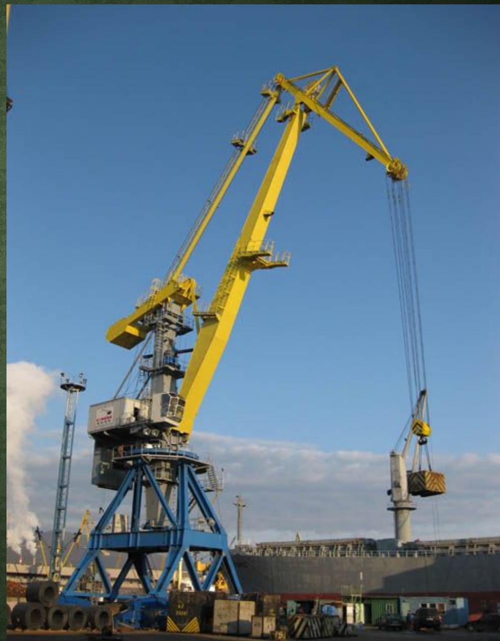
На поворотной платформе размещена кабина 3 с крановыми механизмами: лебедкой, подъема, поворота, изменения вылета стрелы. Конструктивная схема порталного крана характеризуется типом его стрелового и опорно-поворотного
