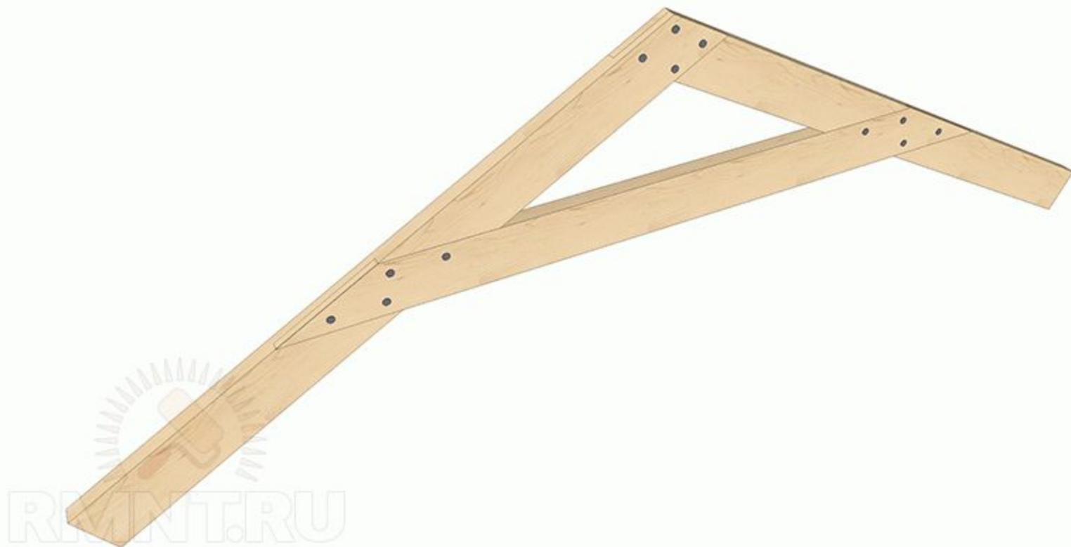
Надрезанные в полдерева торцы можно свести практически под любым углом, это основной метод соединения кровельных ферм. Для скрепления деталей необходима дополнительная стягивающая связь: брус прикладывают к соединенным деталям сбоку на расстоянии в 30-50 см от угла и подрубают в половину толщины по местам соприкосновения, а затем скрепляют конструкцию гвоздями.
