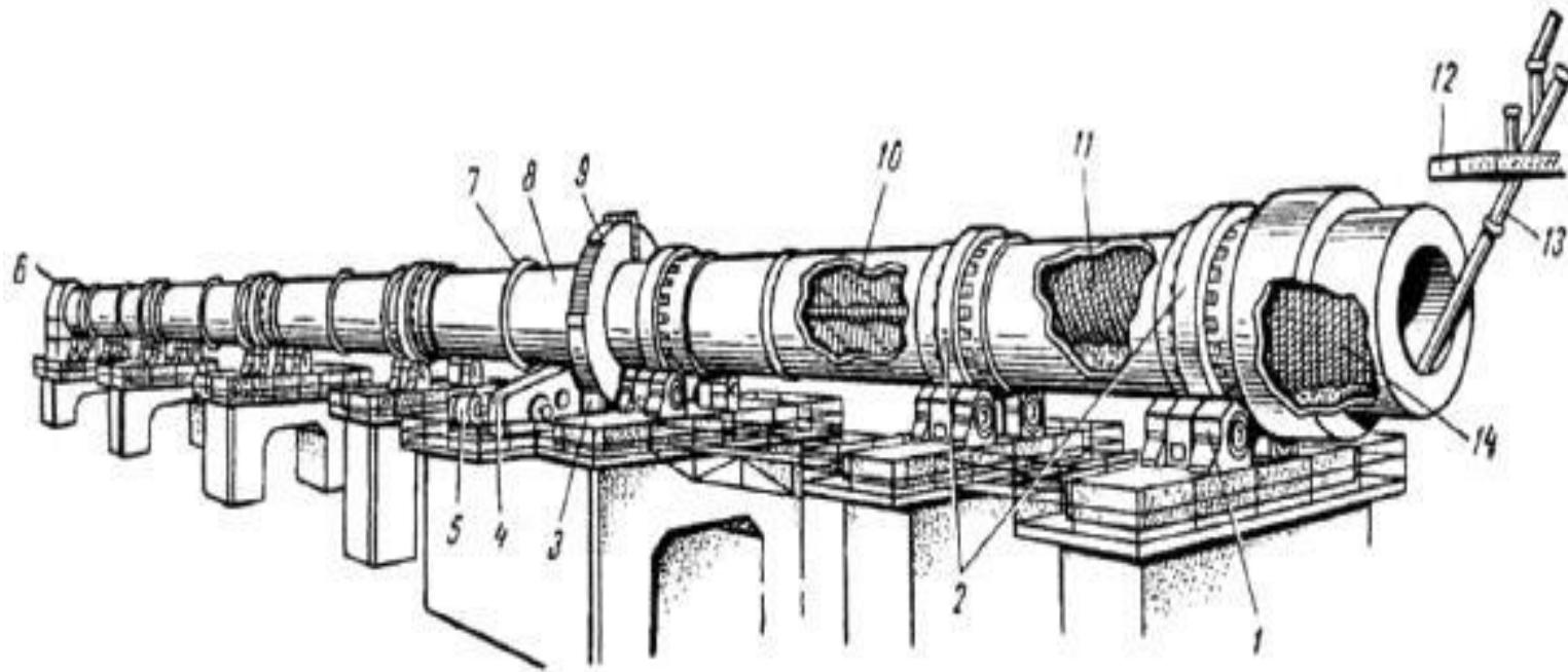
1 - роликовые опоры; 2 - бандажи; 3 - подвенцовная шестерня; 4 - редуктор привода; 5 - электродвигатель; 6 - головка печи; 7 - кольца жесткости; 8 - цилиндрический корпус; 9 - венцовая шестерня; 10, 11 и 14 - теплообменные устройства; 12 - пылеосадительная камера; 13 - течка сырья
