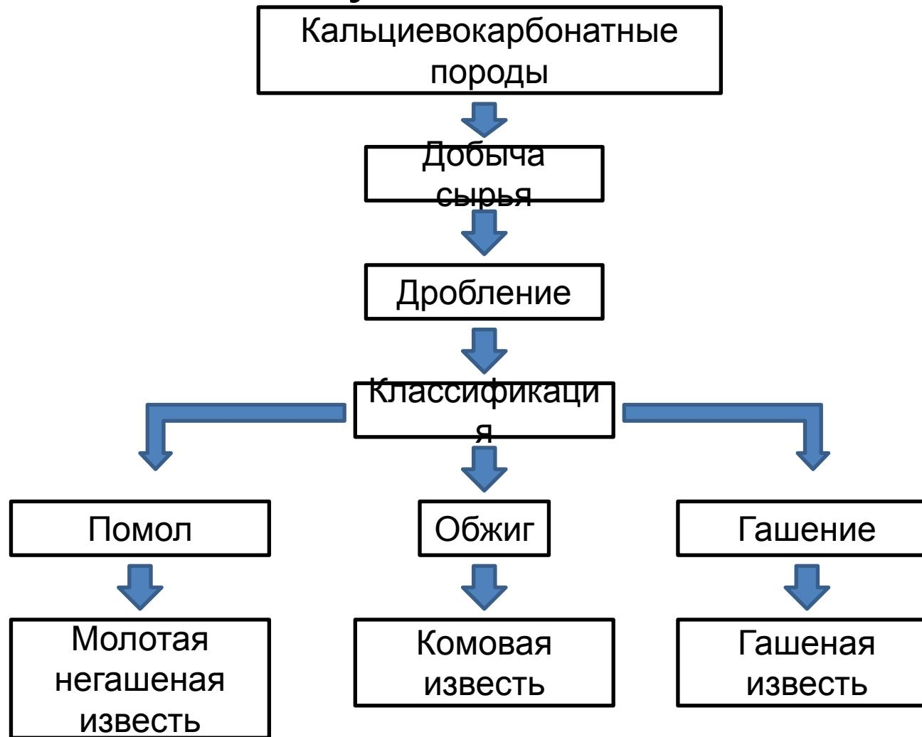
Основным процессом при производстве извести является обжиг, при котором известняк декарбонизуется и превращается в известь.
