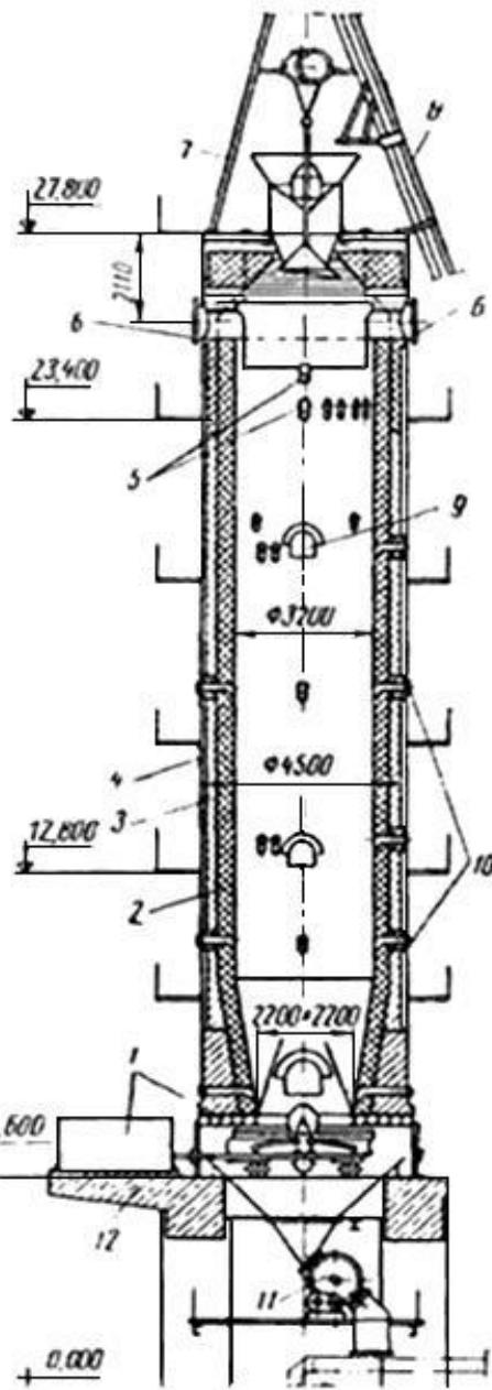
1 - выгрузочный механизм; 2 - футеровка; 3 - слой кладки из легковесного кирпича; 4 - слой теплоизоляционной засыпки; 5 - отверстия для установки датчиков уровня материала шихты; 6 - патрубки для отсоса газов; 7 - загрузочное устройство; 8 - скраповой подъемник; 9 - вспомогательные люки (лазы); 10 - гляделки; 11 -
