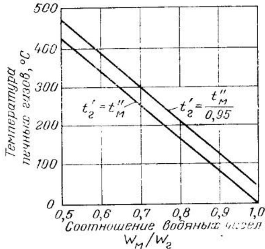
Зависимость конечной температуры печных газов от соотношения водяных чисел
