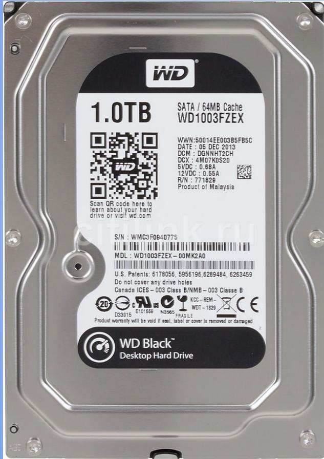
Накопитель на жёстких магнитных дисках, или НЖМД (англ. hard (magnetic) disk drive, HDD, HMDD), жёсткий диск, винчестер — запоминающее устройство (устройство хранения информации) произвольного доступа, основанное на принципе магнитной записи. Является основным накопителем данных в большинстве компьютеров.
