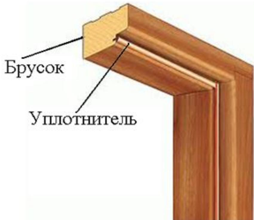
Фрагмент деревянной коробки для дверей и окон
