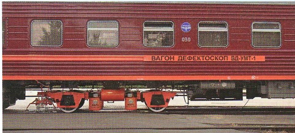
Рис. 1. Вагон-дефектоскоп ВД-УМТ-1
