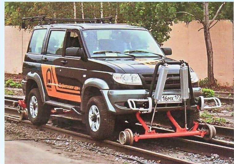
Рис. 4. Лаборатория на комбинированном ходу ЛДМ
