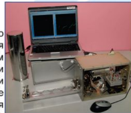
Лазерный анализатор относительного содержания ^{12}\text{CO}_2 и ^{13}\text{CO}_2 в выдыхаемом воздухе
