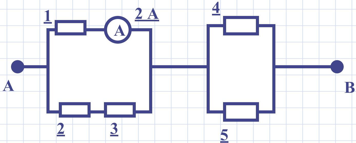
Чему равно напряжение на концах участка АВ , если R<sub>1</sub>=3 Ом, R<sub>2</sub>=2 Ом . R<sub>3</sub>=4 Ом, R<sub>4</sub>=10 Ом,R<sub>5</sub>=10 Ом?
