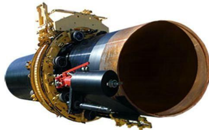
Процесс нанесения изоляции
