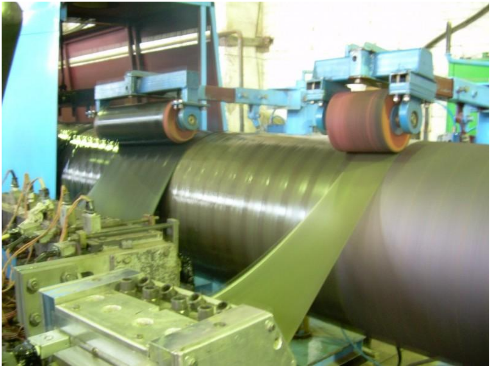
Заводское нанесение полиэтилена на стальную трубу
