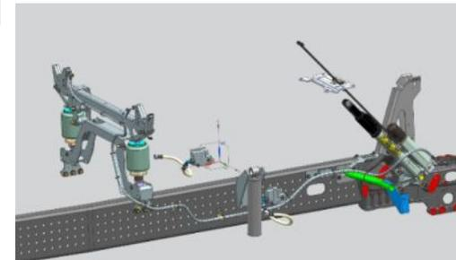
Механизм опрокидывания кабины – моноблок (гидроцилиндр + насос)
