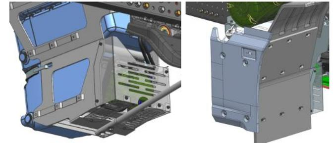
Бак AdBlue – 100 л, совмещен с дозирующим насосом и задней частью крыла. С защитой насоса от грязи, камней
