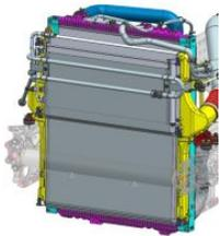
Блок охлаждения под кабину SFTP и двигатель P6
