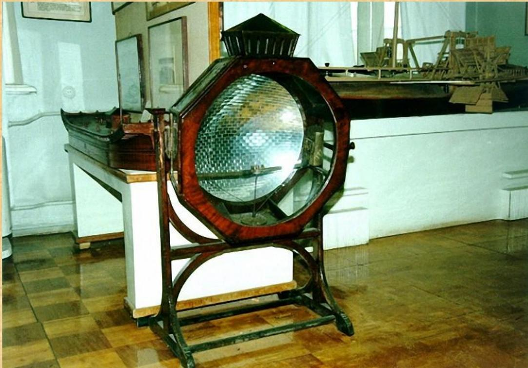
**В 1779 году Кулибин сконструировал знаменитый фонарь-прожектор, который давал сильное освещение при слабом источнике.**
