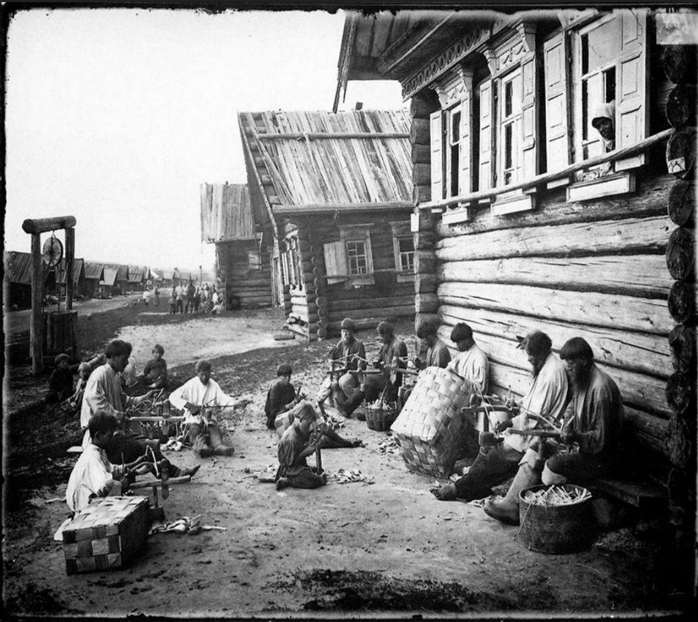
Ложкарное произво Ложкарное производство. Отделка ложечного черенка. 1897 г. Негатив 18x24 смдство. Отделка ложечного черенка. 1897 г. Негатив 18x24 см
