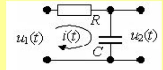
• Установим связь между выходным  $u_2 = F(u_1)$ , считая входной сигнал  $u_1$  произвольным.
