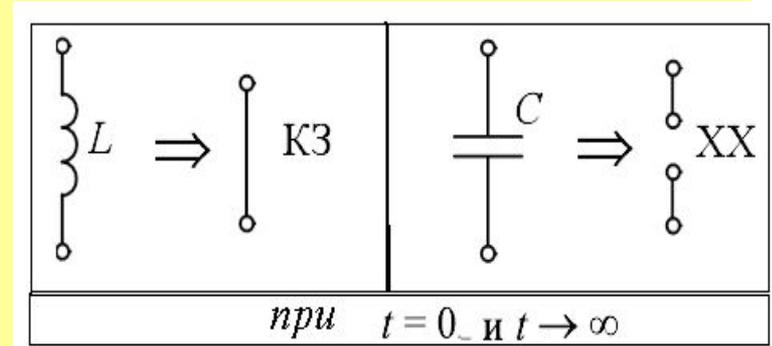
Рис.1.2. Эквивалентные схемы реактивных элементов  $L$  и  $C$  по постоянному току
