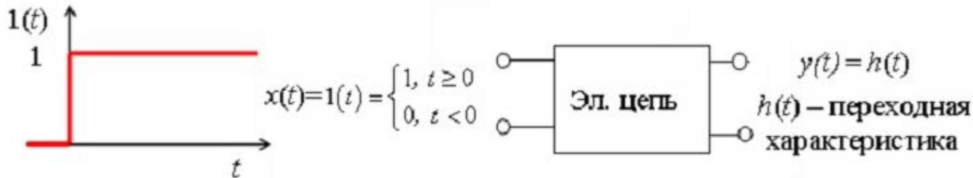
Рис. 1.3. К определению переходной характеристики цепи
