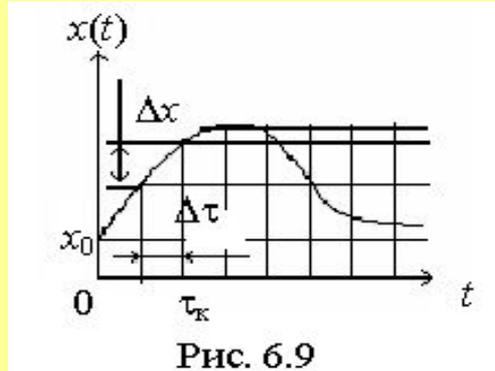
Как следует из рис. 6.9,  $x_0$  – амплитуда нулевого ступенчатого сигнала, при  $t=0$ .
