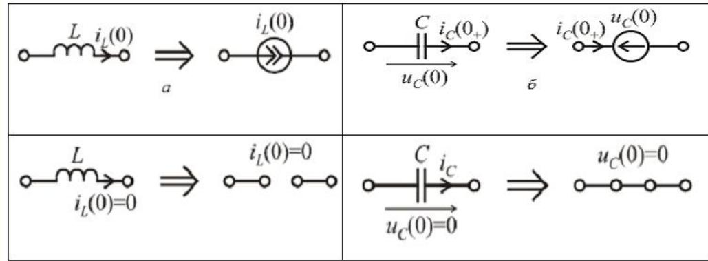
Рис. 1.1. Эквивалентные схемы реактивных элементов при  $t=+0$  ( $\omega \rightarrow \infty$ ).
