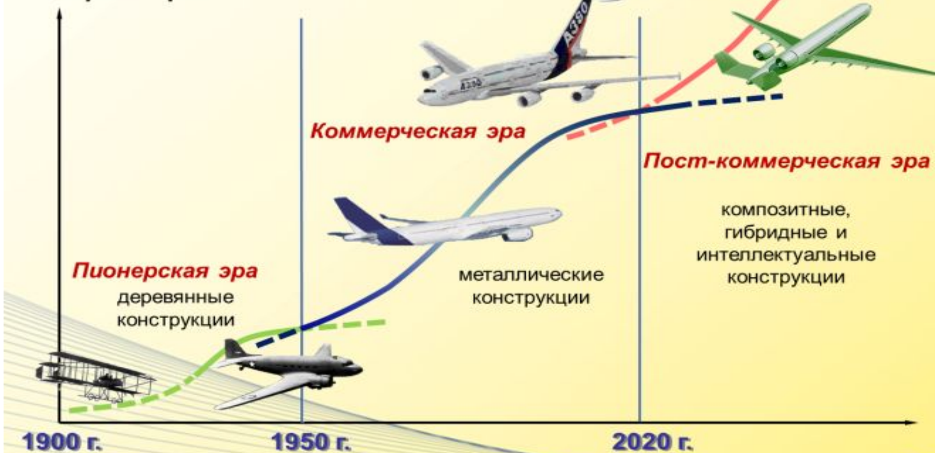
Рис. 1 Основные этапы развития компоновочных и конструктивно-силовых схем гражданских самолетов
