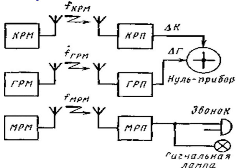
Наземная часть аппаратуры каналов курса, глиссады и маркерного канала для одного направления посадки состоит из курсового, глиссадного и двух (трех) маркерных радиомаяков.
