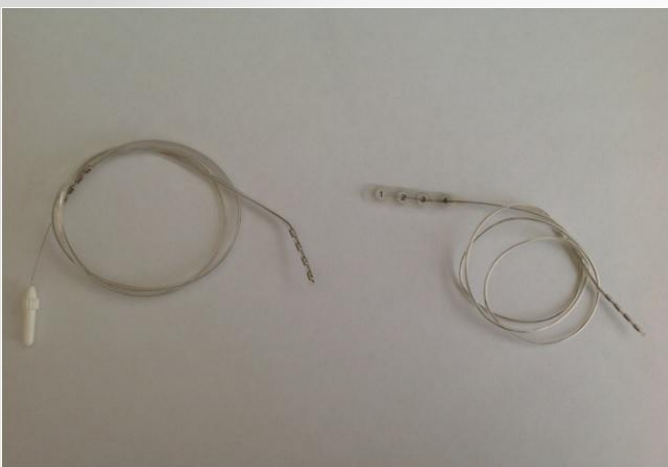
Рис. 5. Электроды для инвазивной регистрации биоэлектрической активности головного мозга (электрод слева для установки в гиппокамп, справа – корковый субдуральный электрод)
