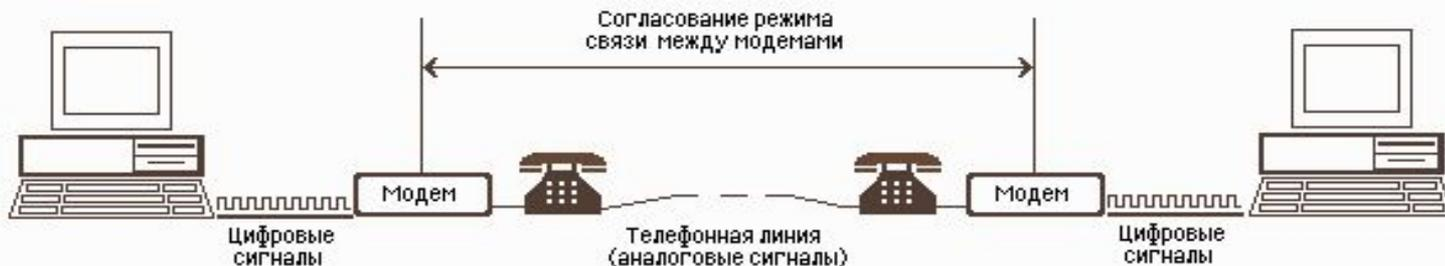
Рис. 2.24. Схема реализации модемной связи
