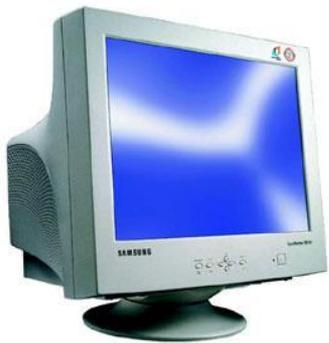
Принцип их действия заключается в том, что формируемый электронной пушкой пучок электронов, попадая на экран, покрытый люминофором, вызывает его свечение. На пути пучка электронов обычно находятся дополнительные электроды: отклоняющая система, позволяющая изменять направление пучка, и модулятор, регулирующий яркость получаемого изображения.
