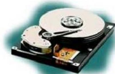
Рис. 2.8. Винчестерский накопитель со снятой крышкой корпуса
