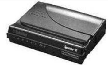
**Модем** — устройство для передачи компьютерных данных на большие расстояния по телефонным линиям связи.
