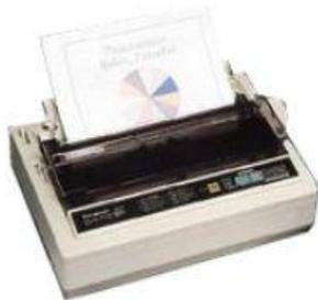
**Точечно-матричные** – это последовательно ударные матричные печатающие устройства, оснащенные печатающей головкой с вертикальным рядом (или 2 рядами) игл или тонких стержней.
