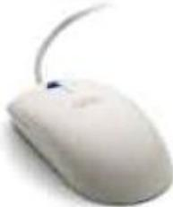
**Мышь** имеет вид небольшой коробки, полностью уместящейся на ладони. Мышь связана с компьютером кабелем через специальный блок — адаптер, и её движения преобразуются в соответствующие перемещения курсора по экрану дисплея. В верхней части устройства расположены управляющие кнопки (обычно их три), позволяющие задавать начало и конец движения, осуществлять выбор меню и т.п.
