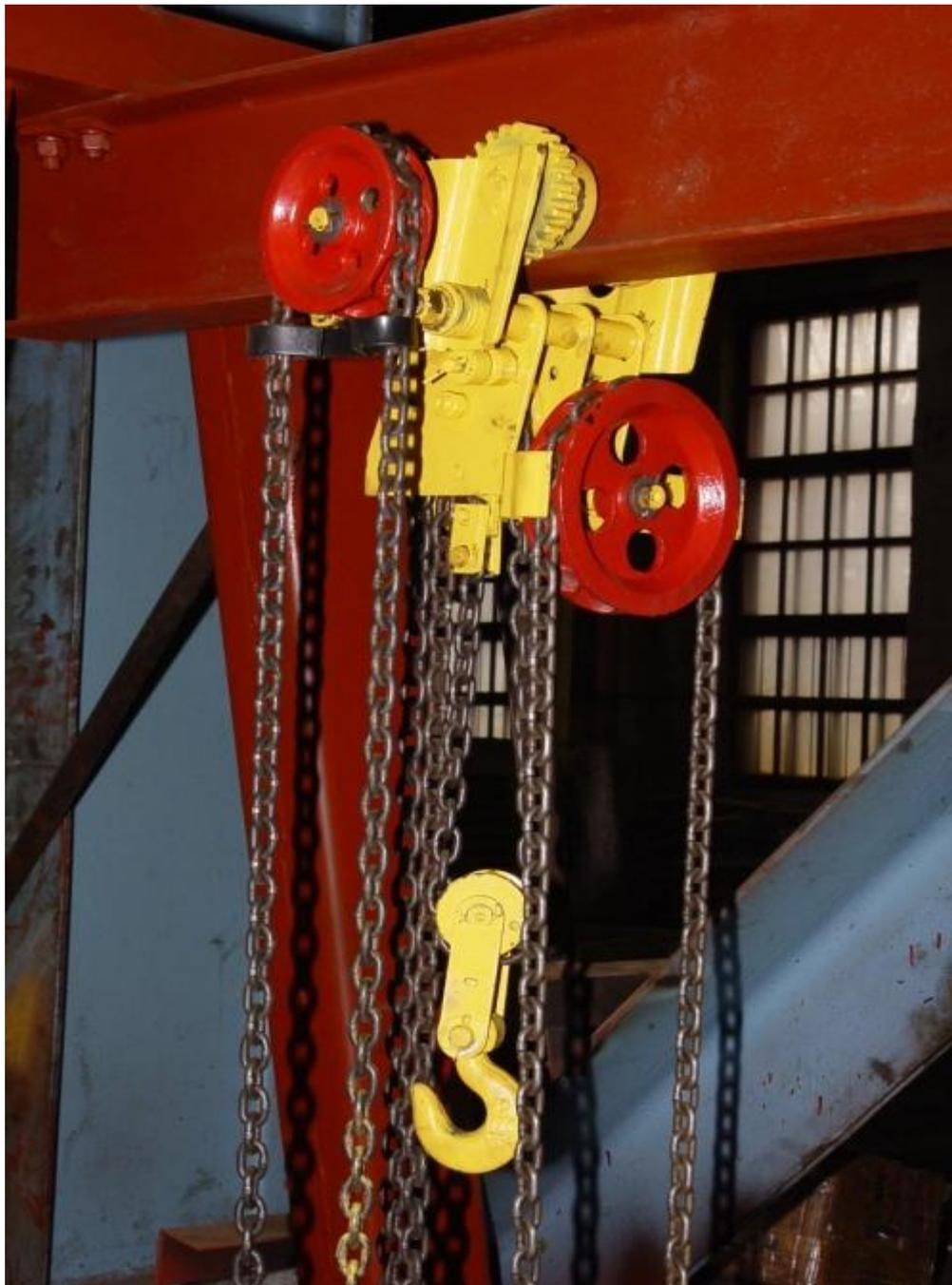
**Червячные ручные тали –** это подъемные устройства, работающие без использования электроэнергии, а потому имеющие максимальную грузоподъемность – 5 тонн. Стоит отметить, что данные тали являются одними из самых мощных ручных устройств, поэтому пользуются большой популярностью на различных предприятиях.
