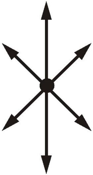
Свет, в котором вектор  $\mathbf{E}$  (и, следовательно,  $\mathbf{H}$ ) колеблется в определенной плоскости, перпендикулярно лучу (рис. 10.4, в), называется **плоскополяризованным (линейно поляризованным)**.
