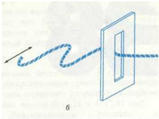
Рис. 10.3,б. Горизонтально поляризованные волны не проходят через вертикальную щель
