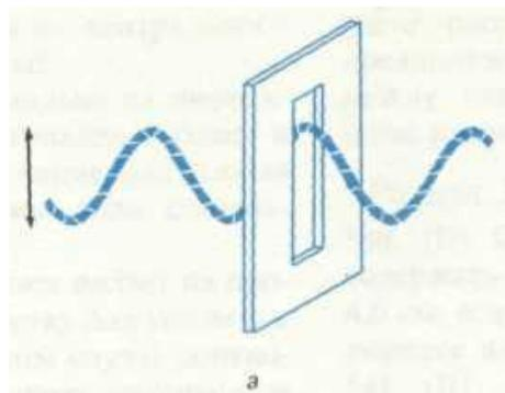
Рис. 10.3,а. Вертикально поляризованные волны проходят через вертикальную щель
