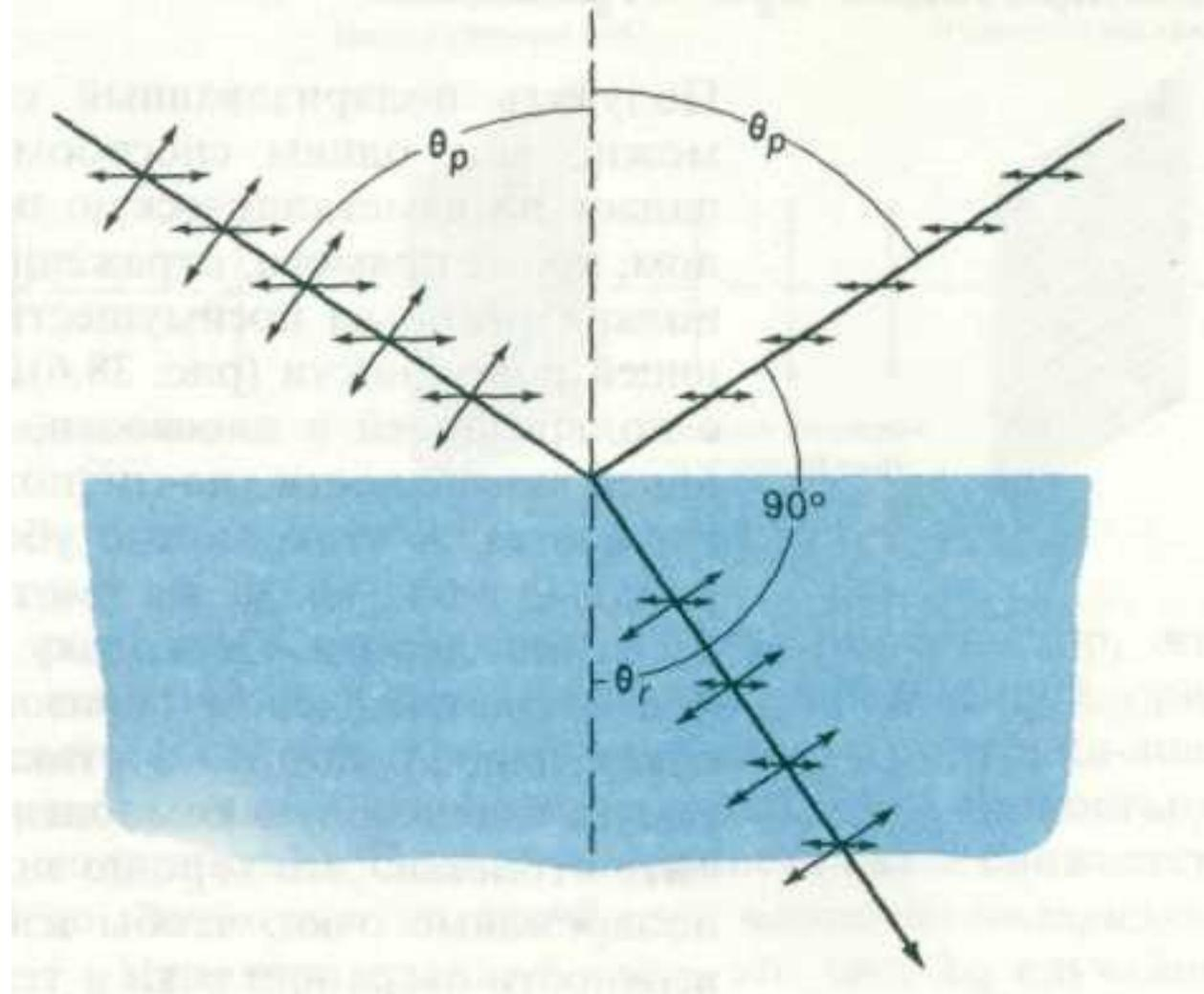
10.7. Свет, отраженный под углом  $\theta_p$ , плоско поляризован параллельно поверхности, и  $\theta_B + \theta_r = 90^\circ$ , где  $\theta_r$  - угол преломления.
