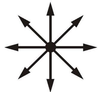
В данном случае равномерное распределение векторов **E** объясняется большим числом атомарных излучателей, а равенство амплитудных значений векторов **E** – одинаковой (в среднем) интенсивностью излучения каждого из атомов.
