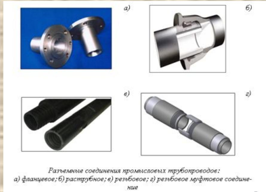
*Разъемные соединения промышленных трубопроводов:
