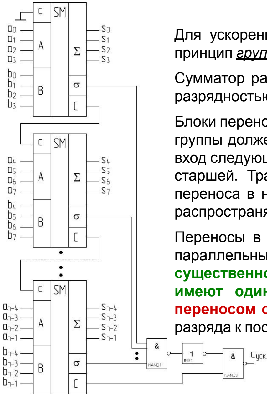
Схема формирования сигналов группового переноса
