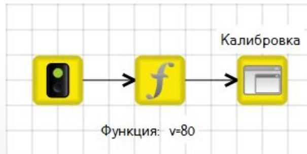
**Калибровка датчика** выполняется для определения граничного условия или желаемого значения (уставки). Оформляется обычно в подпрограмму
