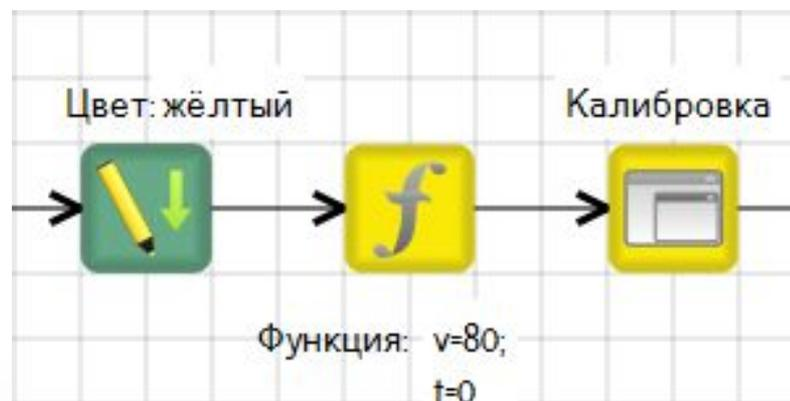
В условии добавьте проверку значения счетчика. При движение вперед счетчик должен накапливаться и обнуляться после отъезда
