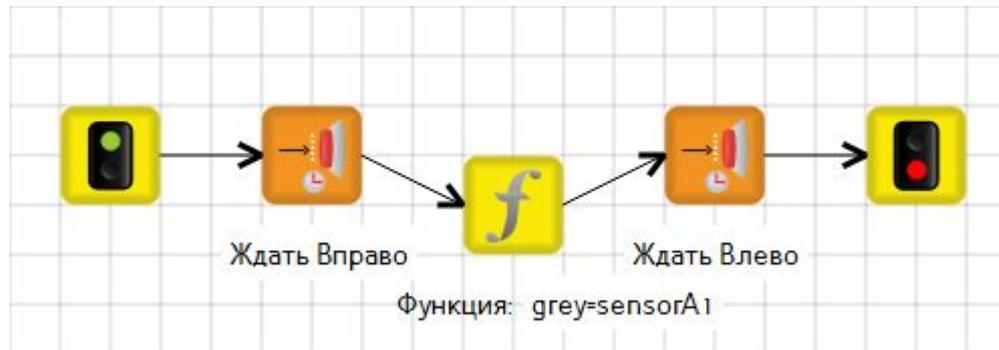
Ожидаем нажатия кнопки «Вправо» на контроллере ТРИК, чтобы успеть переставить робота на границу линии круга. Запоминаем «серое» (grey) значение. Ожидаем нажатие кнопки «Влево», чтобы вернуть робота в центр круга
