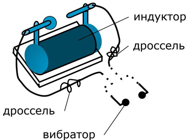
Вибратор состоял из двух медных стержней с шариками-наконечниками, разделенных искровым промежутком. Питание вибратора осуществлялось от индукционной машины (индуктора), на обкладках конденсатора которой создавалось высокое напряжение. Напряжение прикладывалось через дроссели к вибратору (последние нужны для «отсечки» высокочастотных колебаний (тока) в обмотку индуктора).
