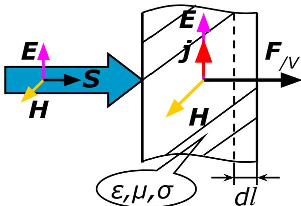
Таким образом, поверхностному слою тела с единичной площадью и толщиной  $dl$  сообщается за промежуток времени  $dt$  импульс:
