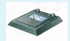
Вольтметр присоединяют к тем точкам цепи, между которыми надо измерить напряжение.
