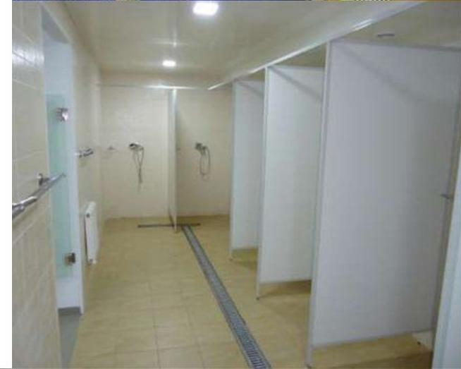
**Санитарные узлы** (уборные) располагают как в комплексе бытовых помещений, так и непосредственно в цехах с таким расчетом, чтобы расстояние от самых удаленных рабочих мест не превышало 75 м, а от рабочих мест на площадке предприятия не более 150 м. В многоэтажных производственных зданиях санитарные узлы располагают на каждом этаже.
