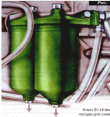
Рис. 6. Слить отстой из фильтра тонкой очистки топлива.
