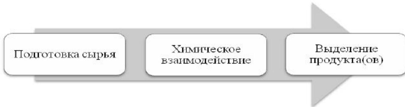
**Технологическая схема** – рационально построенная система единичных аппаратов, соединённых различными видами связей, позволяющая получить заданный продукт заданного качества.
