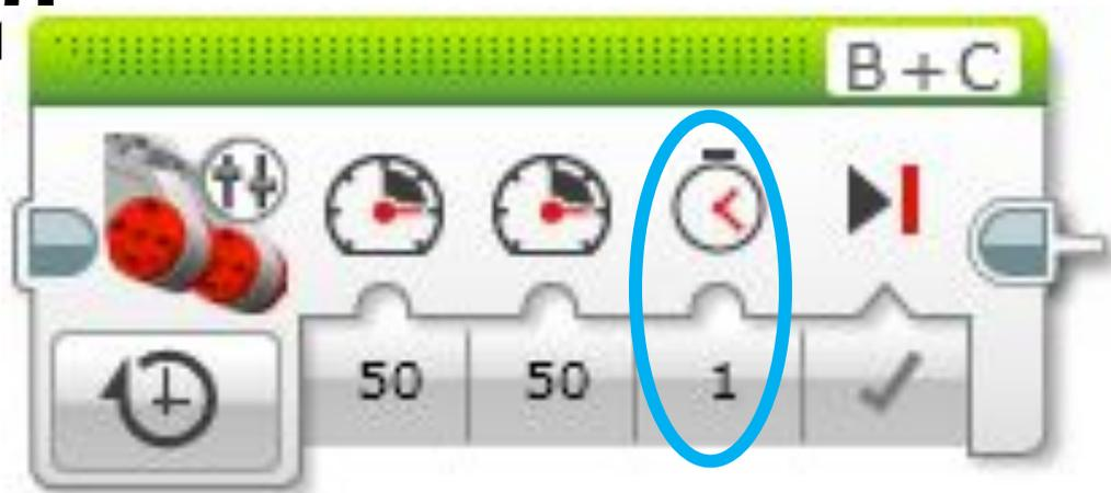
Режим включает оба мотора на количество секунд, указанное во вводе «Секунды», а затем выключает их. Блок будет ожидать, пока истечет время, прежде чем программа перейдет к следующему блоку.
