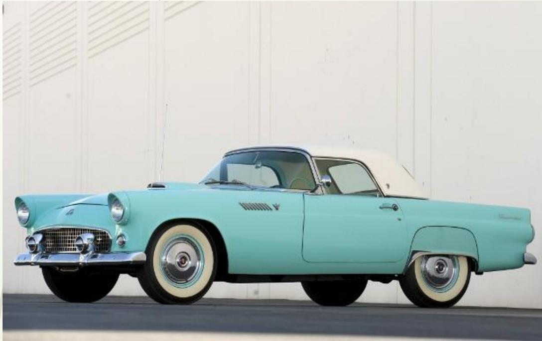
Первое поколение (1955—1957 годы), представляло собой маленький двухместный кабриолет с цельнометаллическим кузовом на массивной несущей раме с X-образной поперечиной, съёмным стеклопластиковым жёстким верхом (тканевый откидной предлагался только в виде опции) и мощным (193 л. с. по стандарту SAE) мотором Y-Block V8 от «Меркури» рабочим объёмом 292 кубических дюйма (4,8 л), созданный как ответ на появление модели Chevrolet Corvette.
