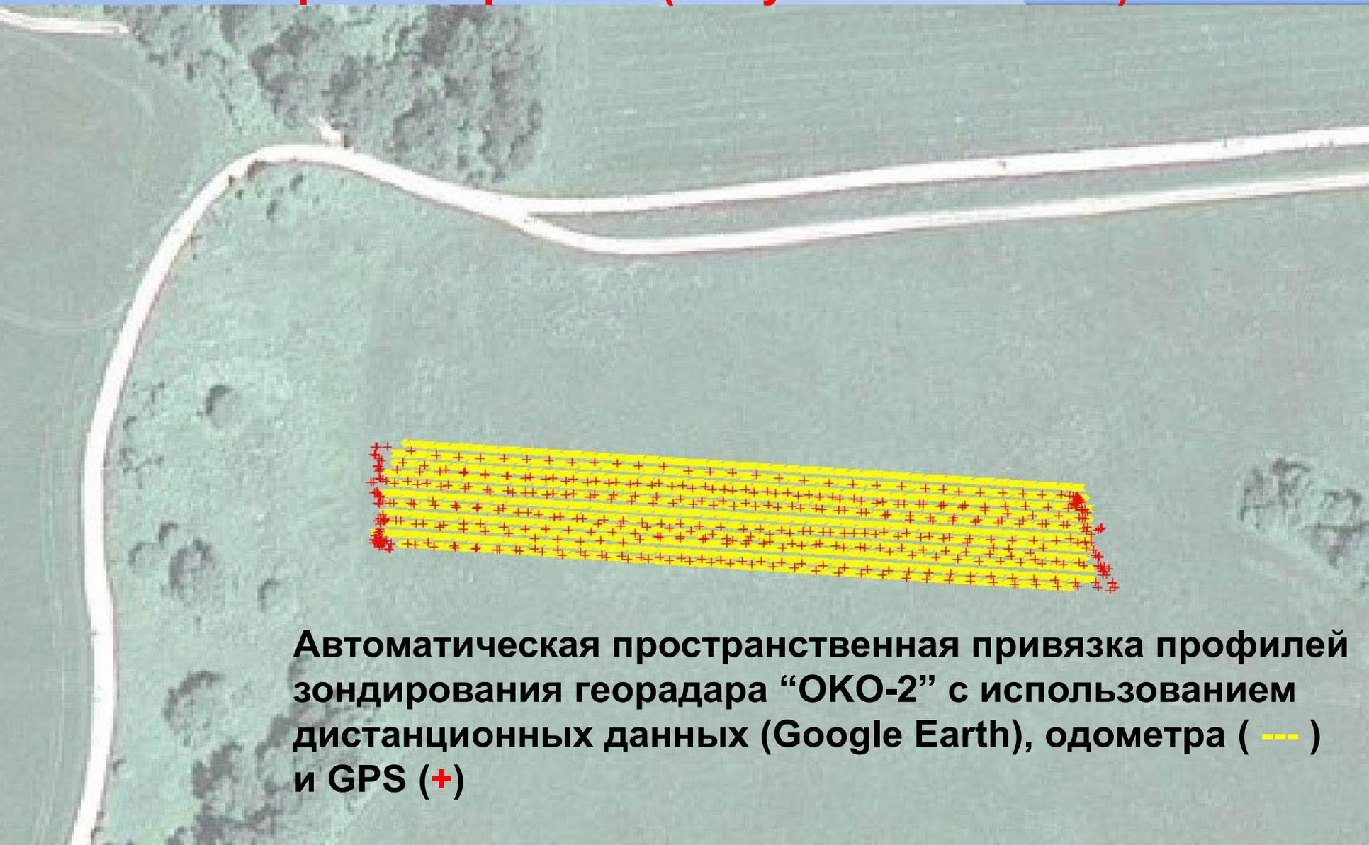
Автоматическая пространственная привязка профилей зондирования георадара “ОКО-2” с использованием дистанционных данных (Google Earth), одометра ( --- ) и GPS (+)
